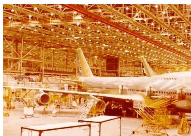
エンジン取付け後は、目の前の大扉が開けられ、新鮮な外の空気を受けながら、牽引車(トーリング・トラクター)に引っ張られ、よいよ外に出されます。
