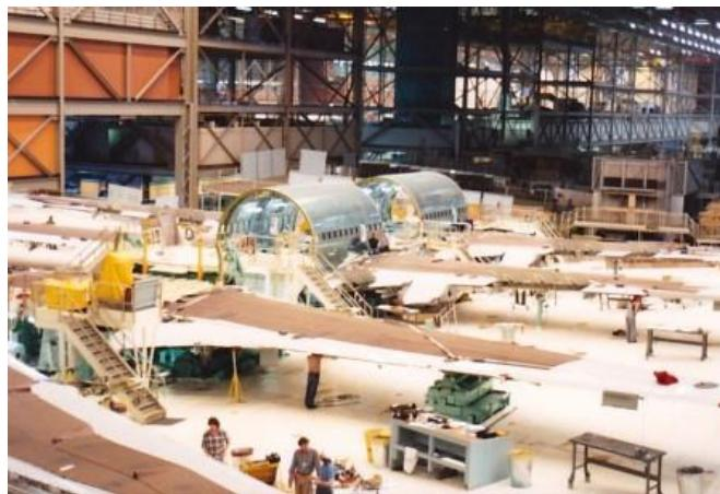
その中間胴体の前方には、2階客室(アッパー・デッキ)・前方客室・前方貨物室(フォワード・カーゴ・ルーム)が一体化した前方胴体が取り付き、さらにその前方には操縦室(コックピット)・前脚降着装置(ノーズ・ランディング・ギア)が収納される構造部分が一体になった先端胴体が取り付けます。
