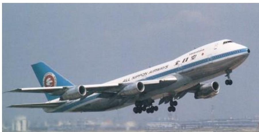
その後エンジン・パワーが上昇推力(クライム・パワー)に少し戻されて、そして高揚力装置・フラップが少しずつフル・アップまで戻されたら、巡航速度(クルーズ・スピード)まで加速されていきます。
